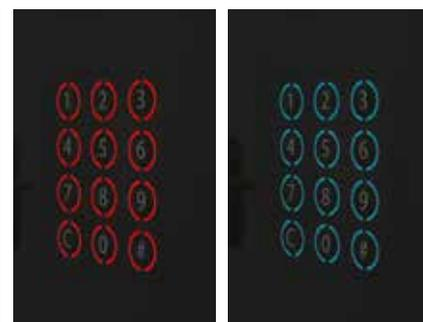
Teclado táctil retroiluminado con iluminación RGB, con diferentes avisos en función del evento que se lleve a cabo.
