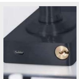
Llave de emergencia y conector micro-USB en la base de la cerradura
