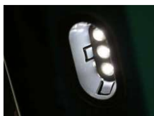
Iluminación interior, LEDs de bajo consumo
