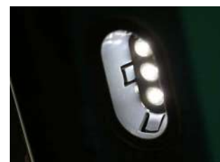
Iluminación interior, LEDs de bajo consumo
