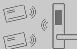
Las **tarjetas de proximidad BTV** utilizan la **tecnología RFID** con **almacenamiento de la información encriptada** para evitar usos fraudulentos
