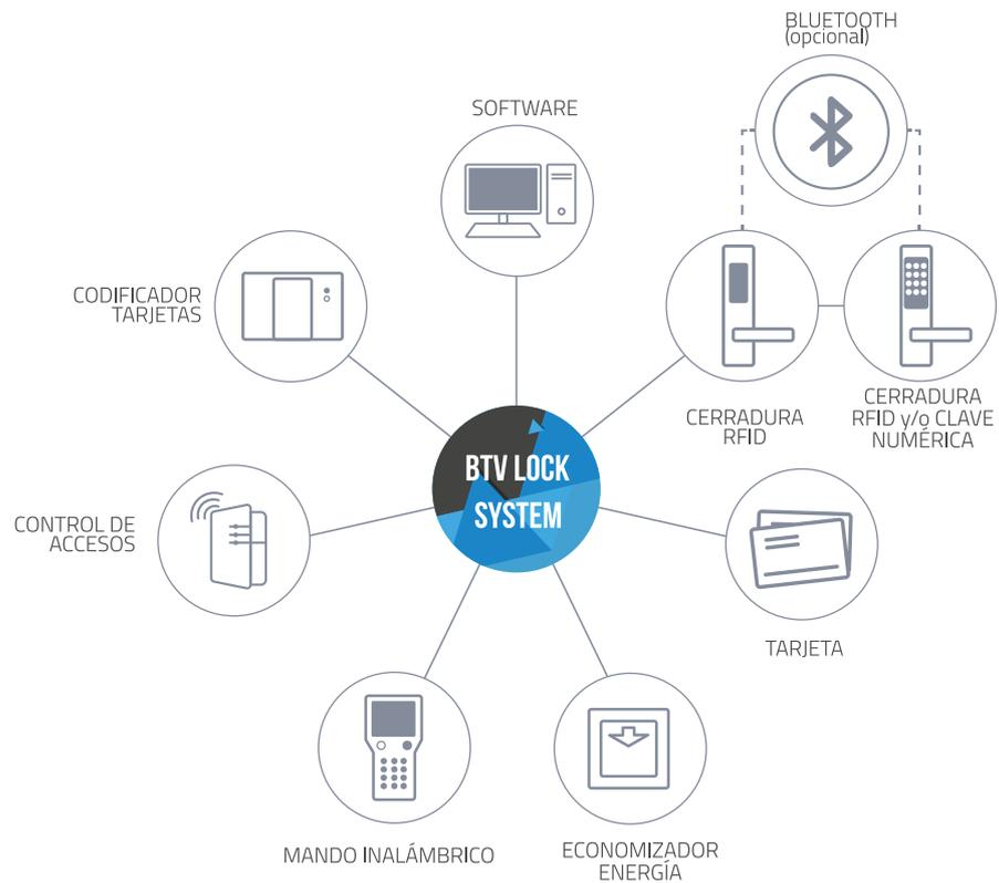
El sistema de gestión hotelera BTV LOCK SYSTEM se basa en la tecnología RFID o identificación por radiofrecuencia con apertura mediante tarjeta de proximidad sin contacto y/o apertura con clave numérica para el modelo Senator y también opcionalmente a través de Bluetooth.
