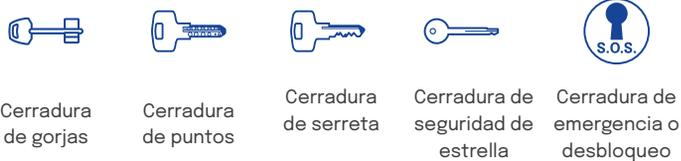
Cerradura de gorjas    Cerradura de puntos    Cerradura de serreta    Cerradura de seguridad de estrella    Cerradura de emergencia o desbloqueo
